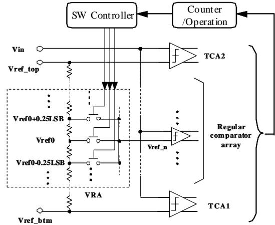
FIGURE 4 ARCHITECTURE OF OFFSET CANCEL CIRCUIT
